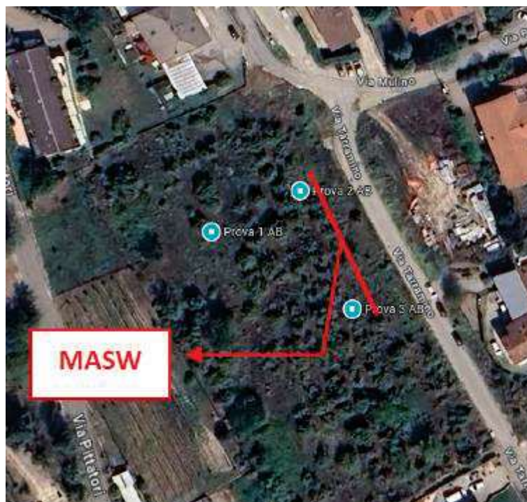
Figura 6 - Ubicazione prove penetrometriche e stendimento sismico.
